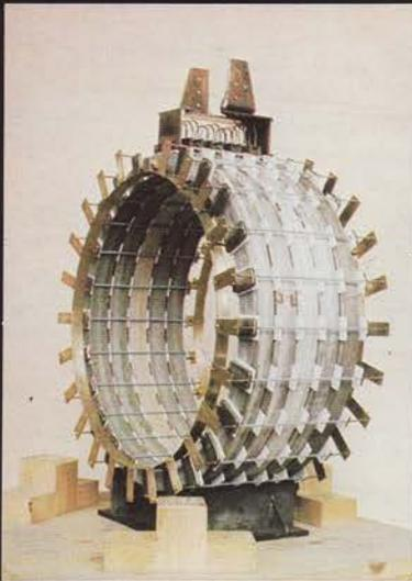
*Bobina superconduttrice realizzata nei laboratori ANSALDO per l'eccitazione di un generatore sperimentale.*
