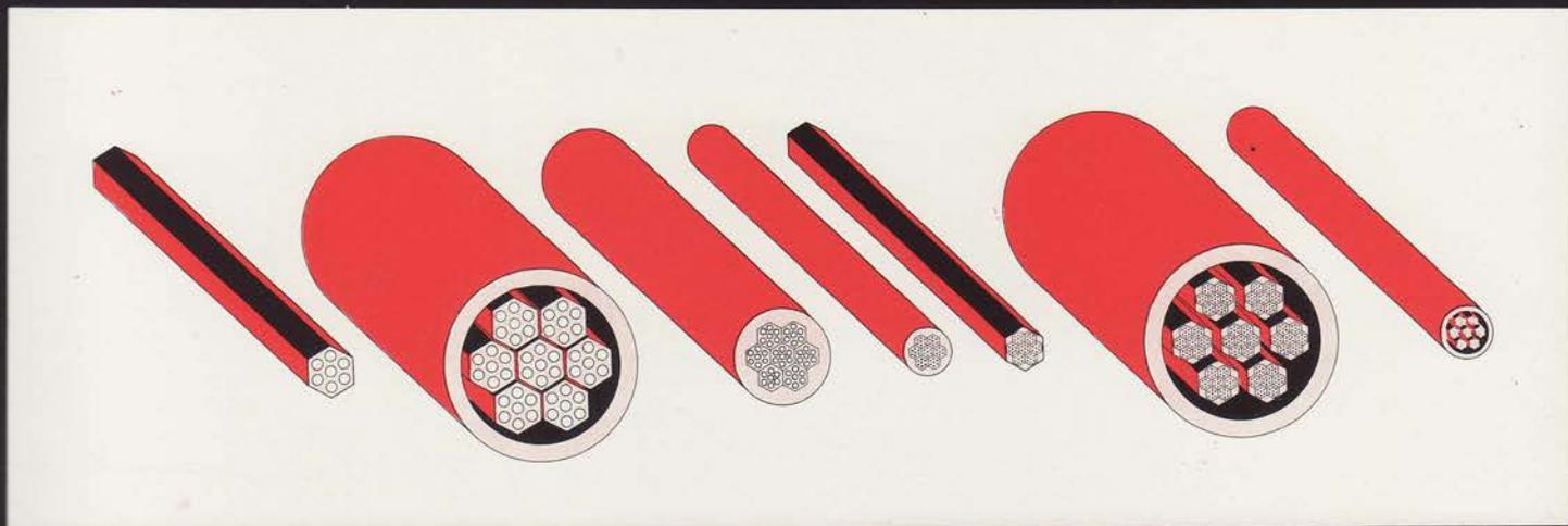
*Schemi di due tipi di cicli per la preparazione di superconduttori multifilamentari.*
