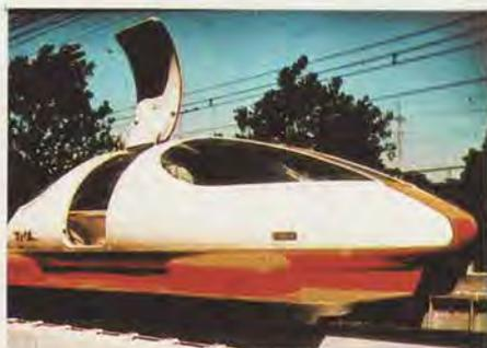
*In basso: Pista sperimentale circolare installata a Erlangen (Germania) della lunghezza totale di ca. 900 m - Velocità massima raggiunta 200 Km/h, così limitata a causa delle forze centrifughe.*
